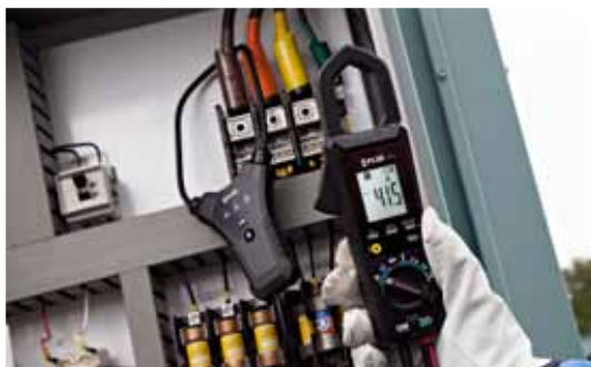
オプションTA74フレックスクランプアクセサリで計測可能な範囲が広がる
